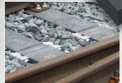
\* Die Schwellen werden von beiden Seiten eingebaut und erst nachdem mit einander verbunden; ideal an Stellen mit begrenztem Arbeitsraum und man braucht außerdem weniger tief zu graben. Die Steifigkeit bleibt konstant über die gesamte Länge der montierten Schwelle aufgrund des einzigartigen Designs.
